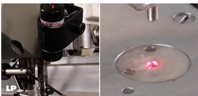
Laser – používá se pro provedení kontroly umístnění vzoru vůči podávacímu rámečku nebo šablone. Tím je zabráněno nechtěnému mechanickému poškození stroje z důvodu špatné velikosti rámečku vůči vytvořenému vzoru nebo kvůli jeho osovému posunu.
