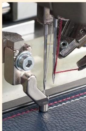
Automatická výměna jehel umožňuje šít dívma barvami nitě při jednom upnutí šitého díla. Dochází k zvýšení produktivity výroby, snížení počtu strojů.
