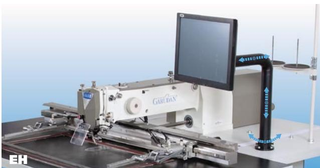
Držák LCD panelu – ergonomický stavitelný držák LCD panelu je standardní součástí dodávky stroje.
